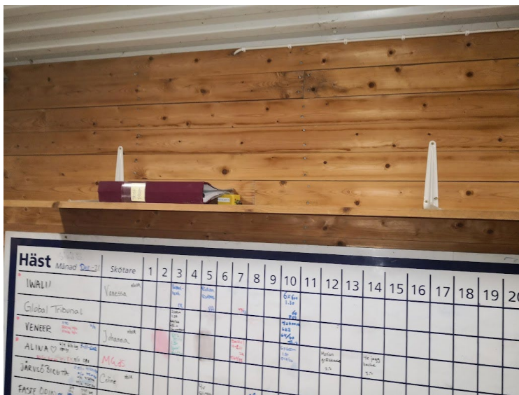
Liten gul Tiny Tag-enhet på hyllan för registrering av temperaturen på sex mätpunkter varje timme under hela försöket.
