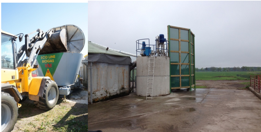
Figur 1. Utrustning som användes under fullskaleförsöken för att konvertera hästgödseln till en pumpbar slurry.
